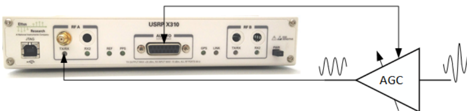
Prinzip SDR und variable Verstärkungsschaltung
